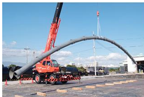
耐震管 GX形ダクタイル鋳鉄管
