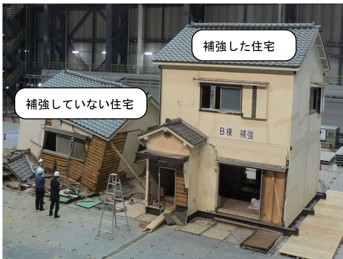
振動実験結果 出典：国立研究開発法人防災科学技術研究所
