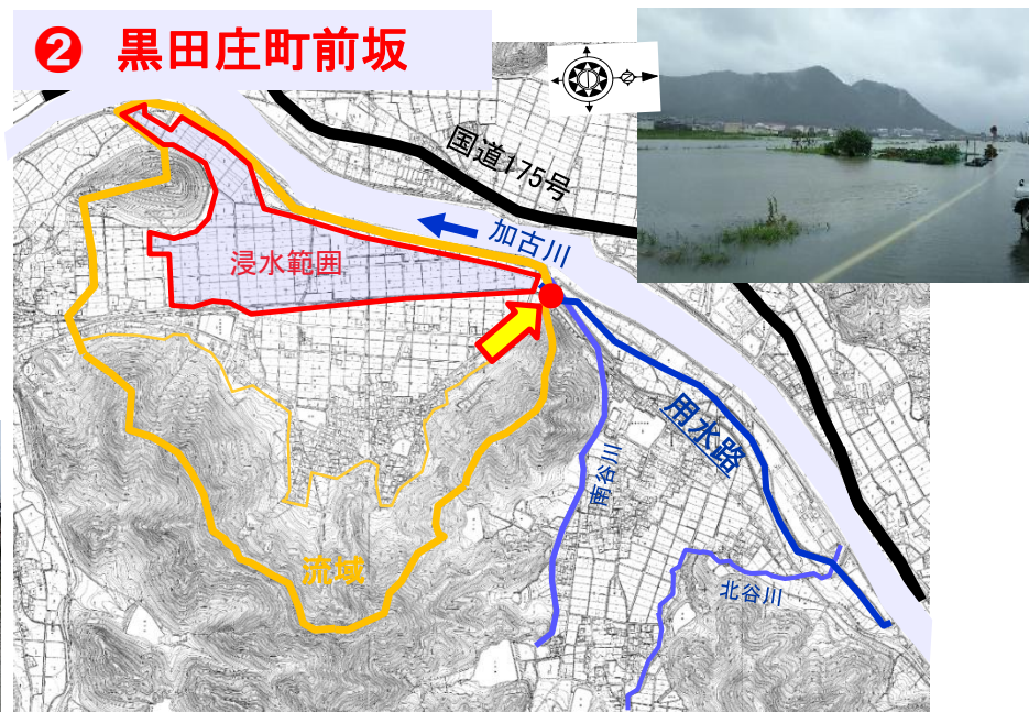
[30年7月豪雨時] 加古川の水位上昇に伴い、加古川へ排水できなくなった上流部（流域外）の雨水が用水路を伝わり流入し、浸水した
