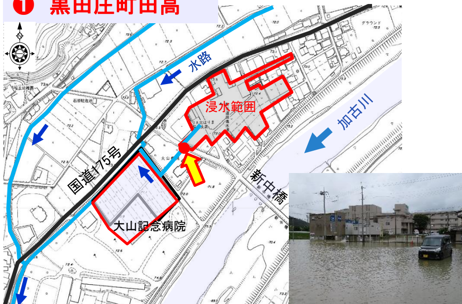
[30年7月豪雨時] 加古川の水位上昇により水路が逆流し、浸水被害が発生
