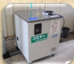
ゴミ処理分解消滅機生ゴミが水とガスに分解されます。
