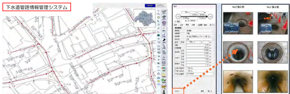
下水道管路情報管理システム
